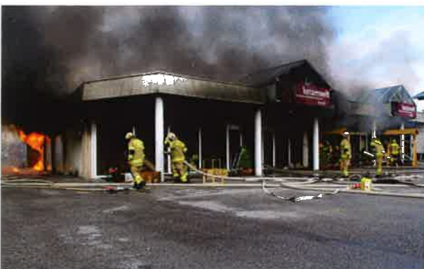
Großbrand in einem Verkaufsgeschäft für Kerzen Brandursache: Wärmestau durch Scheinwerfer
