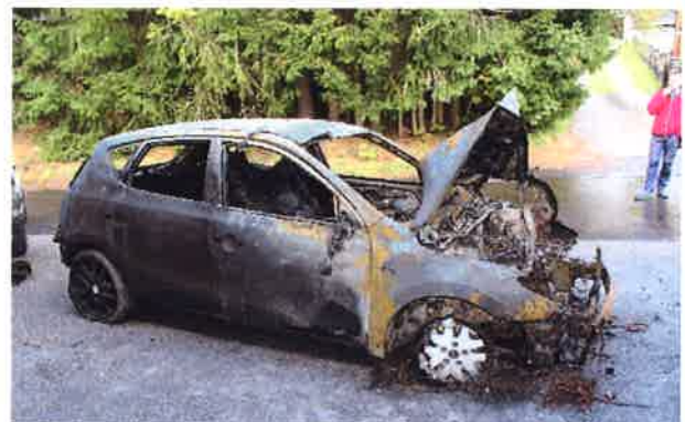
Fahrzeugbrand Brandursache: technischer Defekt (Batterie)
